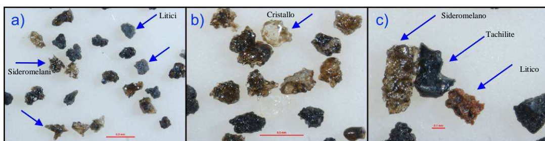
Figura 6 – Immagini acquisite allo stereo-microscopio che illustrano la cenere del campione NCSE171113-7 emessa dal NSEC: a) panoramica con indicati a sinistra clasti di sideromelano, a destra clasti litici lavici; b) cristallo di plagioclasio; c) da sinistra a destra particelle di sideromelano, tachilite e litico arrossato. La barra rossa di scala è 0.5, 0.5, 0.1 mm, rispettivamente. Foto di Maria Deborah Lo Castro.
