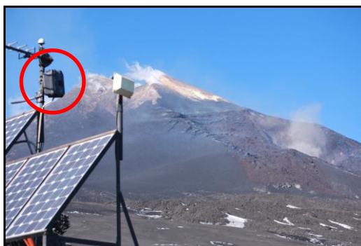
Figura 5: Il radiometro (cerchio rosso) presso il sito del Belvedere puntato verso il Nuovo Cratere di Sud-Est.
