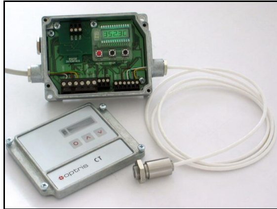
Figura 1: Il radiometro Optrics utilizzato sull'Etna. Il sensore ottico è collegato al radiometro tramite un cavo elettrico
