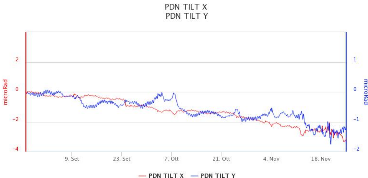
Fig. 6.3 - Segnali clinometrici alla stazione sommitale di Pizzi Deneri. Sono riportate le 2 componenti di PDN nella scala temporale degli ultimi 3 mesi [microradianti].
