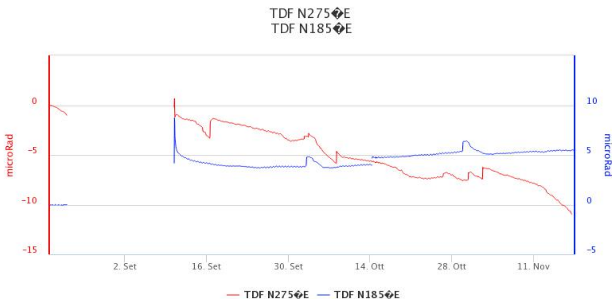
Fig. 5.2 - Variazione dell'inclinazione del suolo alla stazione clinometrica di TDF [microstrain]. Sono riportate le 2 componenti di TDF negli ultimi 3 mesi di registrazione.
