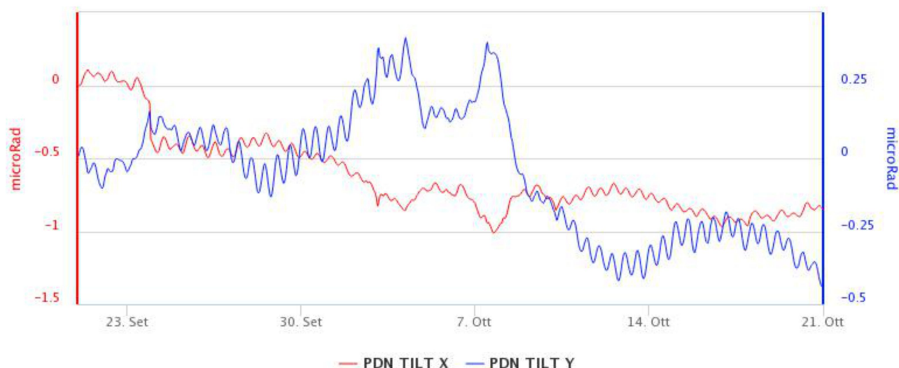
Fig. 6.3 - Segnali clinometrici alla stazione sommitale di Pizzi Deneri. Sono riportate le 2 componenti di PDN nel lungo (un anno, in alto) e nel breve (un mese, in basso)
