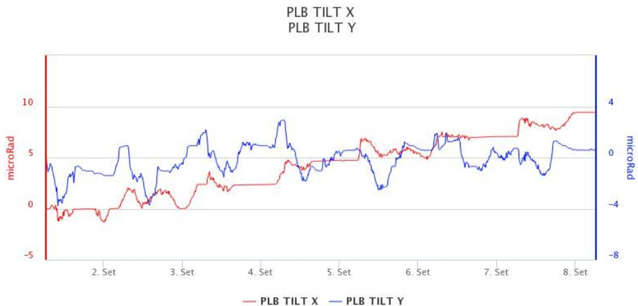
**Fig. 5.2** - *Variazione dell'inclinazione del suolo alla stazione clinometrica di PLB*
