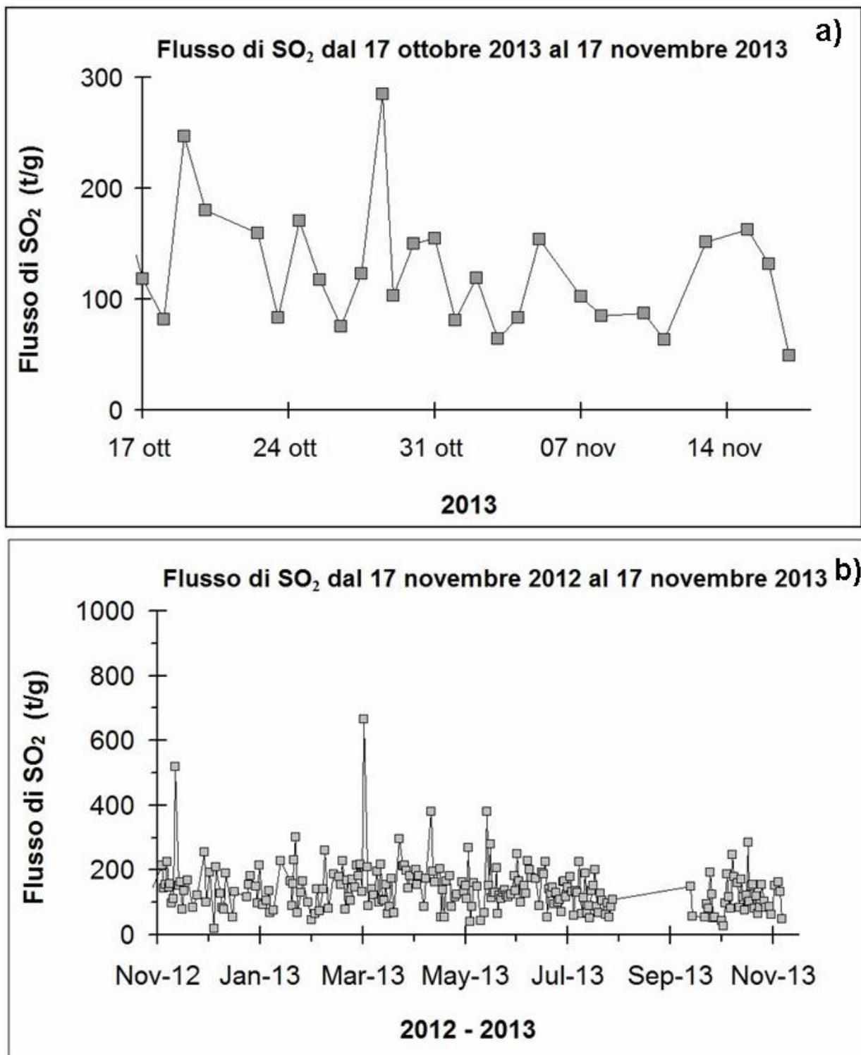
**Fig. 2.3** Andamento temporale del flusso di SO<sub>2</sub>: a) ultimi tre mesi; b) ultimo anno
