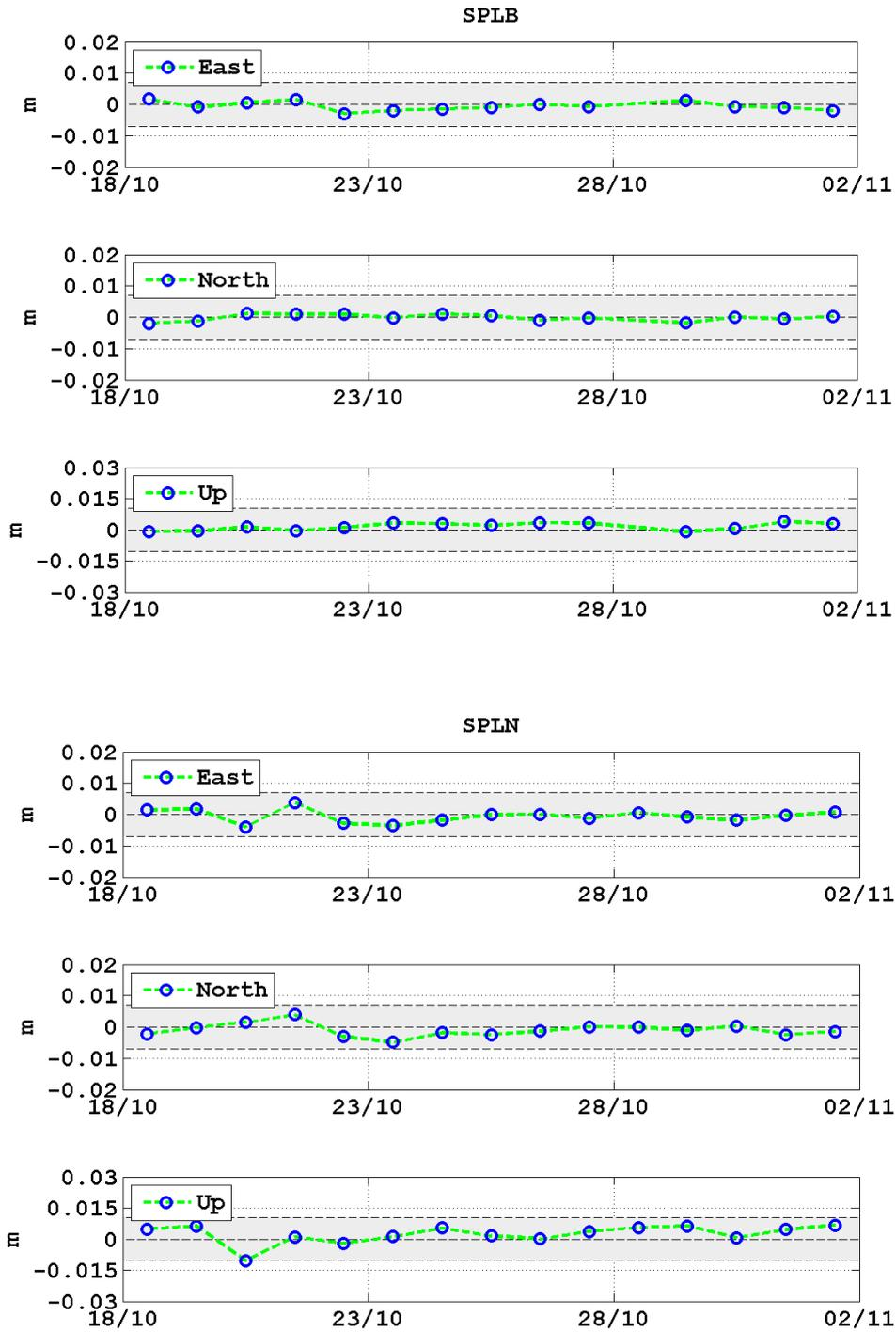
Figura 9 - Serie temporali delle componenti E-W, N-S e quota per gli ultimi 15 giorni delle stazioni CGPS dello Stromboli, calcolate attraverso il software RTD.
