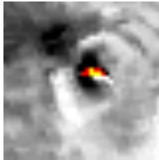
Figura 8. Immagine AVHRR del 27 Maggio 2008 00:27 GMT. In rosso sono identificati i pixel dove il sistema è risolubile; in giallo i pixel dove il sistema è risolubile ma saturati in banda 3; in blu i pixel con probabile contaminazione nuvolosa.
