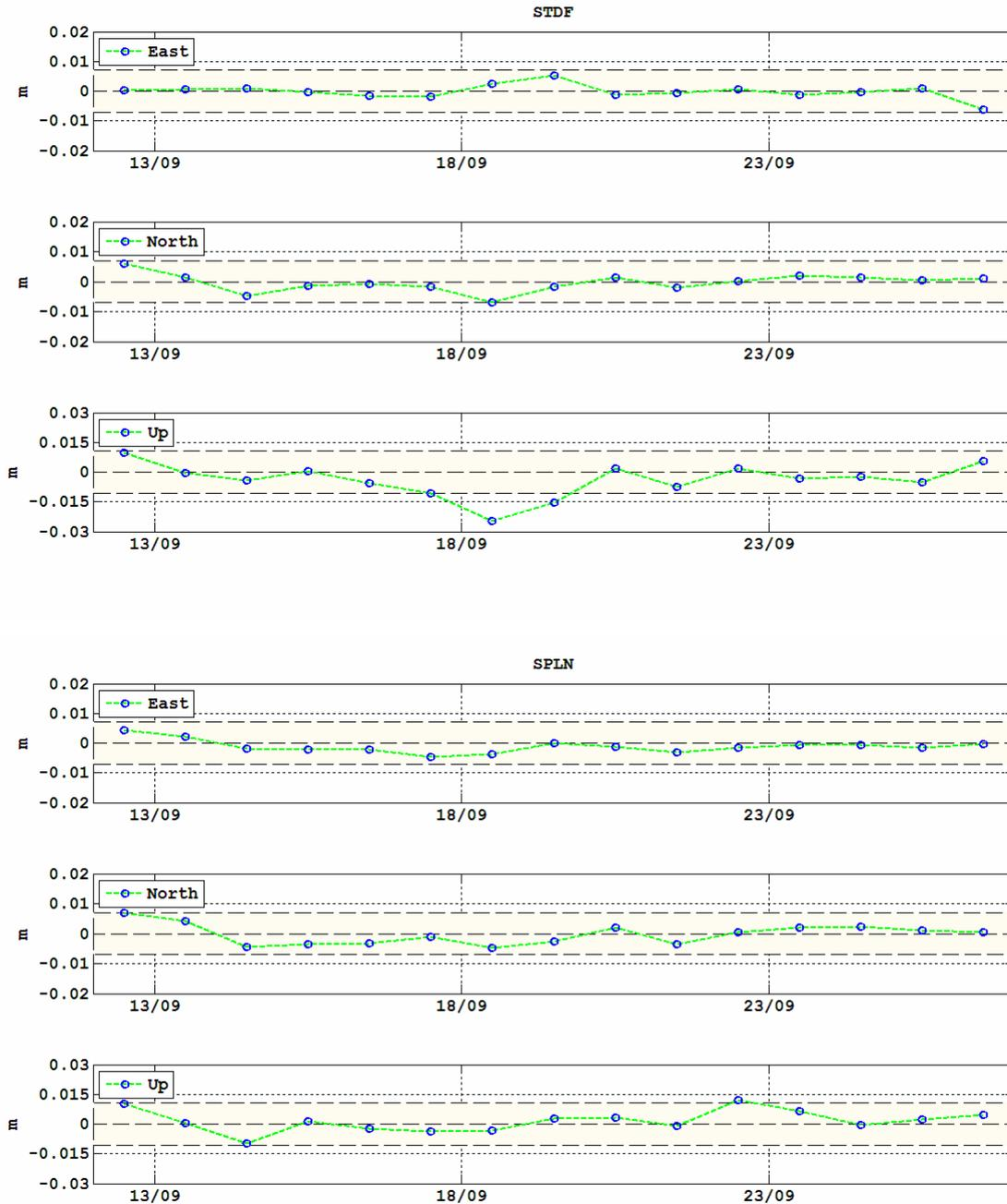
**Figura 12** - Serie temporali delle componenti E-W, N-S e Quota per gli ultimi 15 giorni delle stazioni CGPS dello Stromboli, calcolate attraverso il software RTD.
