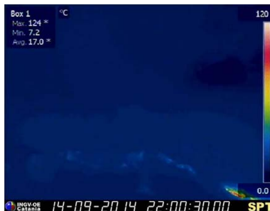
Figura 1. L'immagine termica ripresa dalla telecamera termica del Pizzo mostra in basso a destra l'anomalia termica associata alla bocca effusiva di quota 650 m.
