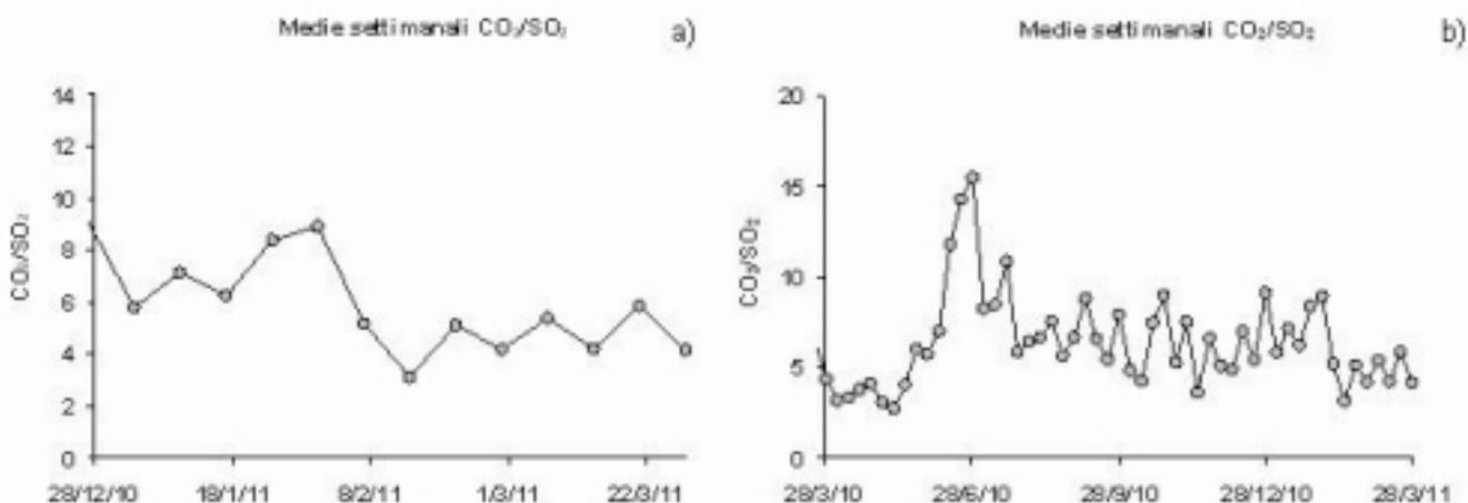
**Fig. 2.2** Andamento temporale del rapporto CO<sub>2</sub>/SO<sub>2</sub> nel plume: ultimi tre mesi (a), ultimo anno (b).
