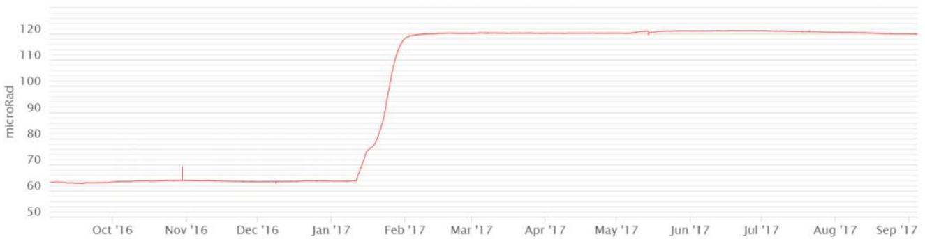
**Fig. 3.1** Variazione dell'inclinazione del suolo alla stazione clinometrica di STDF. Sono riportate le 2 componenti di STDF nel breve (un mese, in alto) e nel lungo periodo (un anno, in basso). La variazione registrata tra gennaio e febbraio 2017 è fittizia.
