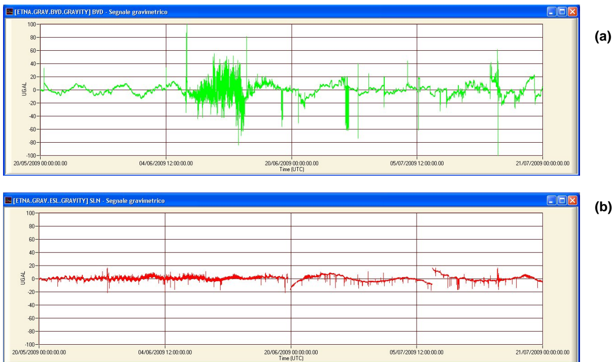
Fig. 3 – (a) segnale gravimetrico acquisito nella stazione di Belvedere (BVD) tra il 20 maggio e il 20 luglio 2009. (b) Segnale gravimetrico acquisito nella stazione di Serra la Nave (SLN) nello stesso periodo.
