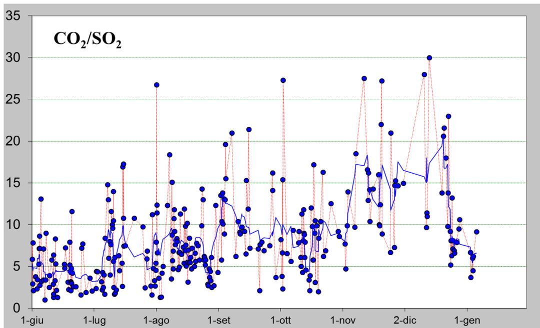
Fig. 2 – Rapporto CO<sub>2</sub>/SO<sub>2</sub> misurato nel plume vulcanico dello Stromboli nel periodo tra il 1 giugno e il 6 gennaio 2015 (ultimo dato ore 6:30 locali del 6 gennaio).
