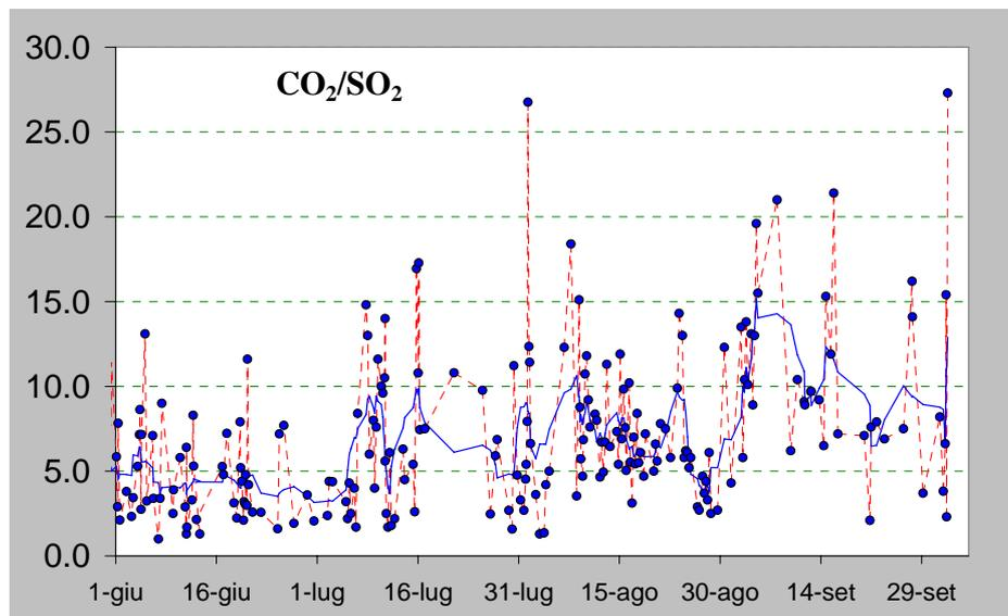
**Figura 4** – Rapporto  $CO_2/SO_2$  misurato nel plume vulcanico dello Stromboli nel periodo 1 giugno - 2 ottobre 2014 (ultimo dato ore 23:30 locali del 02 ottobre).
