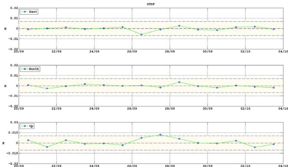
**Figura 12** - Serie temporali delle componenti E-W, N-S e quota per gli ultimi 15 giorni delle stazioni CGPS dello Stromboli, calcolate attraverso il software RTD.
