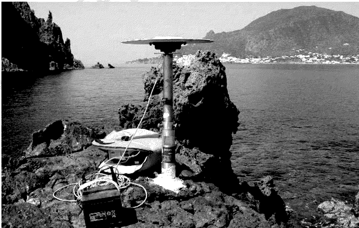
Una stazione GPS installata su un caposaldo geodetico delle isole Eolie. In basso, l'eruzione di Stromboli
