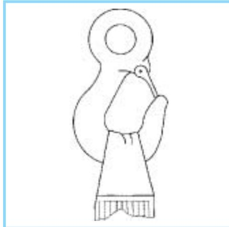
Esempio di braca piatta con occhiello terminale cedevole non compatibile con un gancio il cui raggio di curvatura è troppo piccolo.
