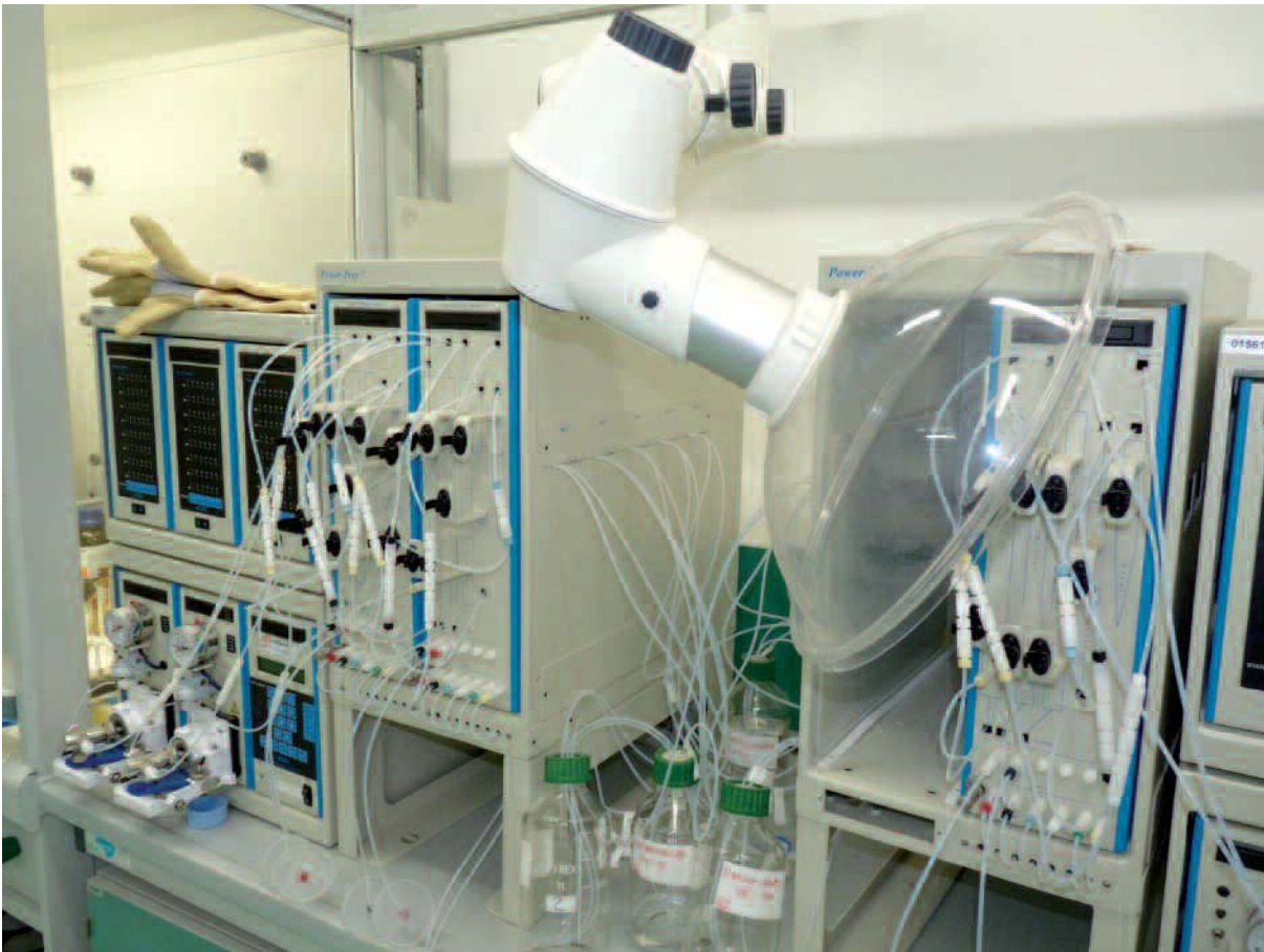
Sistema automatico di purificazione per la determinazione di IPA, PCB e Diossine
