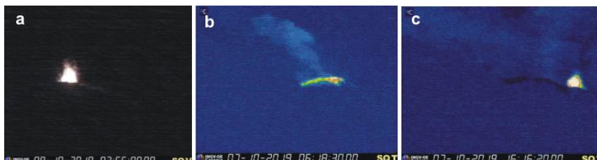
Fig. 3.1 - Immagini visibile (a) e termica (b) dell'attività stromboliana dalle bocche presenti nell'area craterica N, con emissione di cenere e materiale grossolano che ricade sui fianchi del cono prospiciente la Sciara del Fuoco. (c) Immagine termica di un'esplosione da una bocca dell'area craterica CS.
