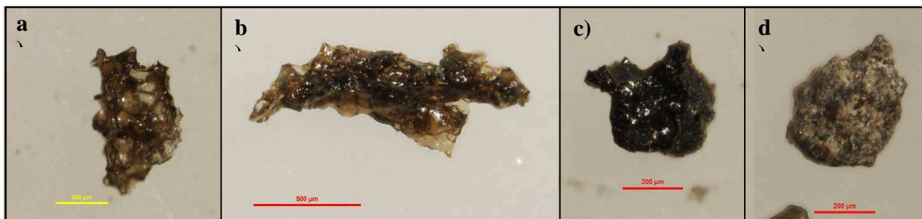
Figura 8. Immagini acquisite allo stereo-microscopio che illustrano: a) sideromelano equigranulare ben vescicolato con superficie frastagliata (scala 200 µm); b) sideromelano allungato con forma fluidale (scala 500 µm); c) tachilite di colore nero lucido con morfologia “blocky” (scala 200 µm); d) particella litica di colore grigiastro (scala 200 µm).
