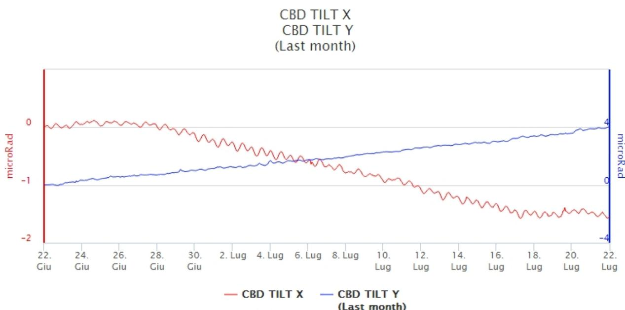
**Fig. 6.3** - Segnali clinometrici alla stazione di Case Bada sul versante nord-orientale. Sono riportate le 2 componenti di CBD nel lungo (un anno, in alto) e nel breve (un mese, in basso).
