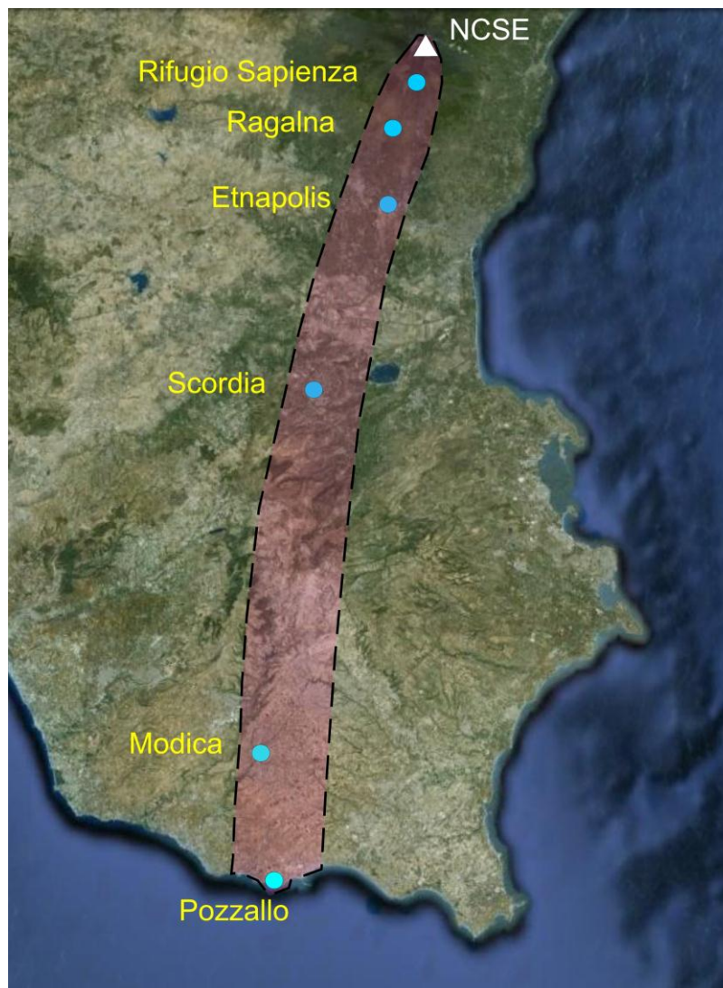
Figura 3 - Mappa preliminare della dispersione del deposito di caduta di piroclastiti della fontana di lava del 18 aprile 2013 rappresentato su Google-Earth.
