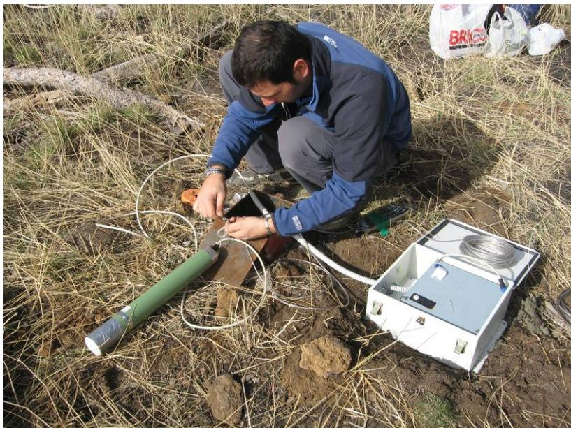
*Fig. 6 – Cablaggio dei cavi di trasmissione e posizionamento all'interno del foro.*
