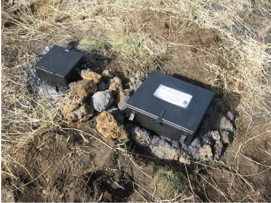
*Fig. 7 – Ammorsamento e mimetizzazione delle custodie della sonda barasol e del data-logger.*
