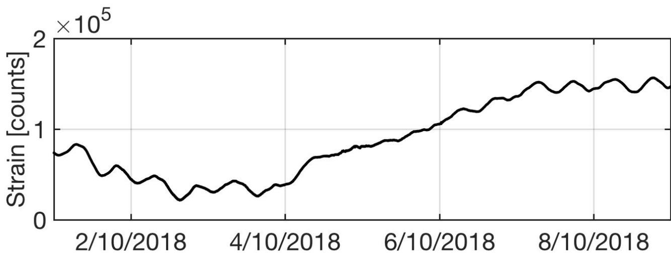
**Fig. 4.4** - Grafico relativo ai dati dilatometrici registrati a SVO: in nero viene mostrato il dato processato, ripulito dalle maree.
