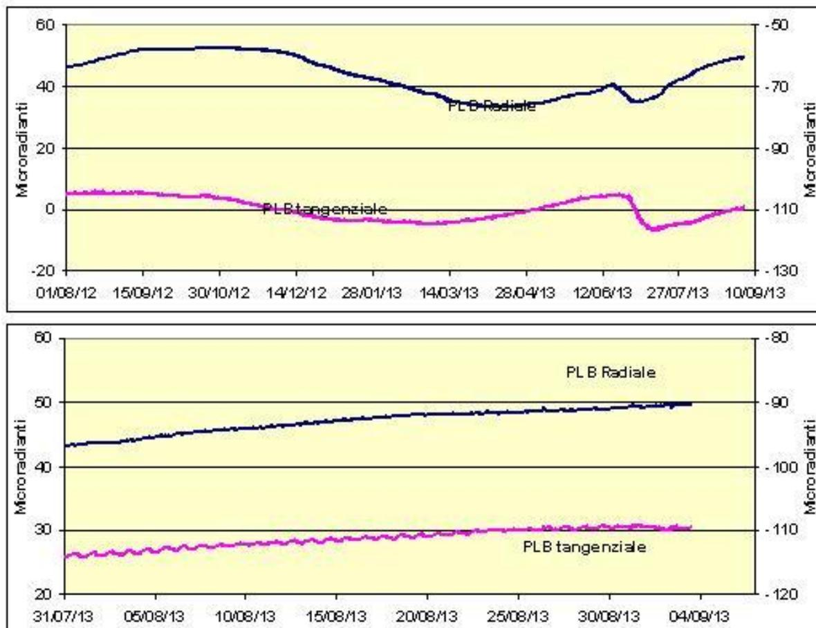
**Fig. 3.1** Variazione dell'inclinazione del suolo alla stazione clinometrica di PLB. I grafici riportano le componenti radiali e tangenziali di PLB nel lungo e nel breve periodo.
