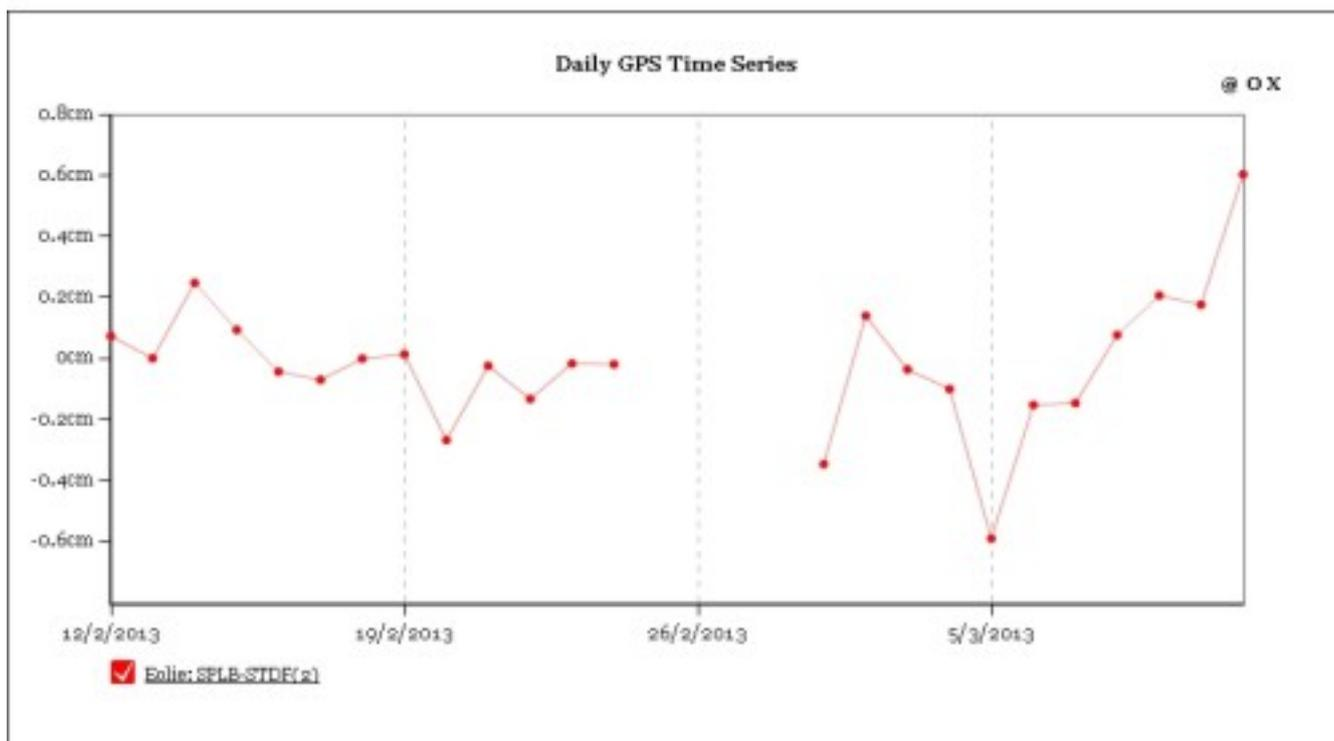
**Fig. 3.2** Fig. 3.2 Variazione della Distanza Reale (Slope Distance) tra le stazioni GPS permanenti di Punta Labronzo (SPLB) e Timpone del Fuoco (STDF), nei due intervalli di un anno (in alto) e di un mese (in basso).
