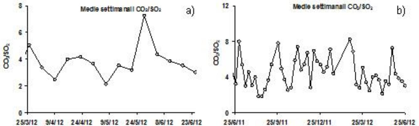
**Fig. 2.2** Andamento temporale del rapporto CO<sub>2</sub>/SO<sub>2</sub> nel plume: ultimi tre mesi (a), ultimo anno (b).
