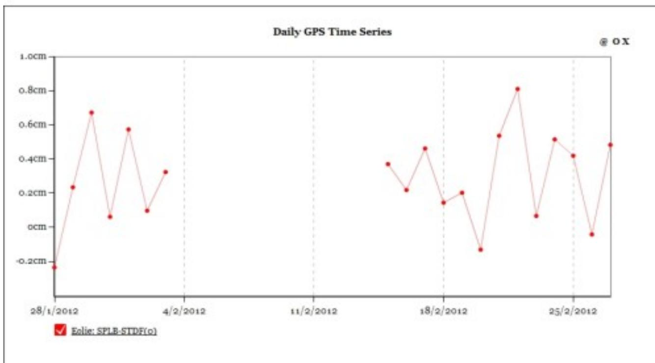
**Fig. 3.2** Variazione della Distanza Reale (Slope Distance) tra le stazioni GPS permanenti di Punta Labronzo (SPLB) e Timpone del Fuoco (STDF), nei due intervalli di un anno (in alto) e di un mese (in basso).
