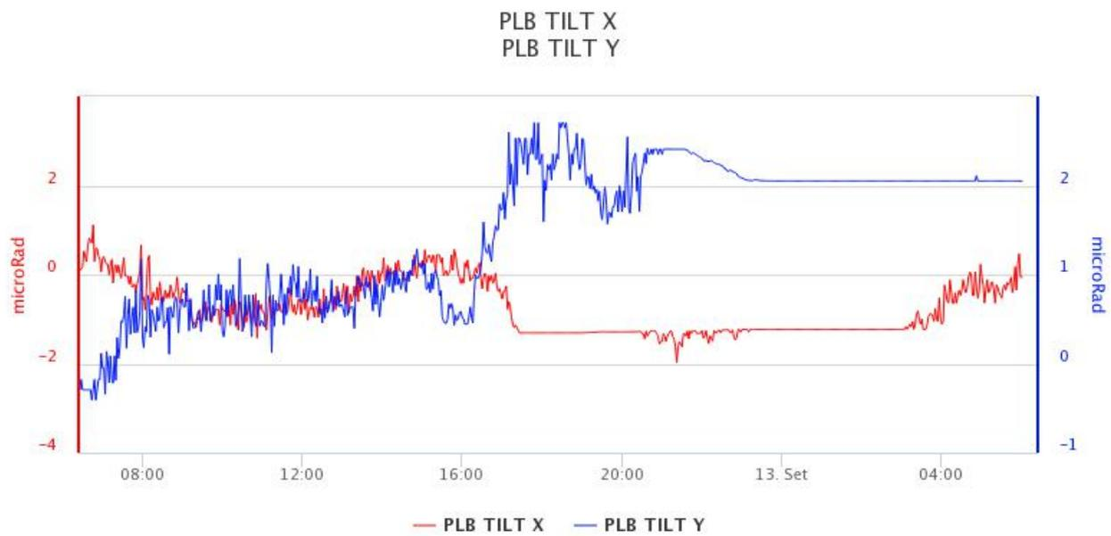
**Fig. 5.2** - Componenti X e Y del segnale tilt
