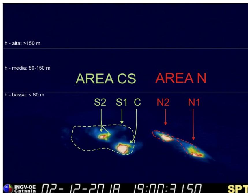
**Fig. 3.1** - La terrazza craterica vista dalla telecamera termica posta sul Pizzo sopra la Fossa, con i settori in cui è divisa la terrazza craterica (AREA N, AREA C-S). Le sigle e le frecce indicano i nomi e le ubicazioni delle bocche attive. L'areale soprastante la terrazza craterica è diviso in tre intervalli di altezze (h) che indicano l'intensità dell'esplosioni.
