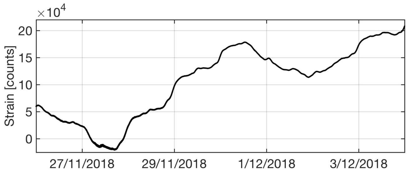
**Fig. 4.4** - Grafico relativo ai dati dilatometrici registrati a SVO: viene mostrato il dato processato, ripulito dalle maree.
