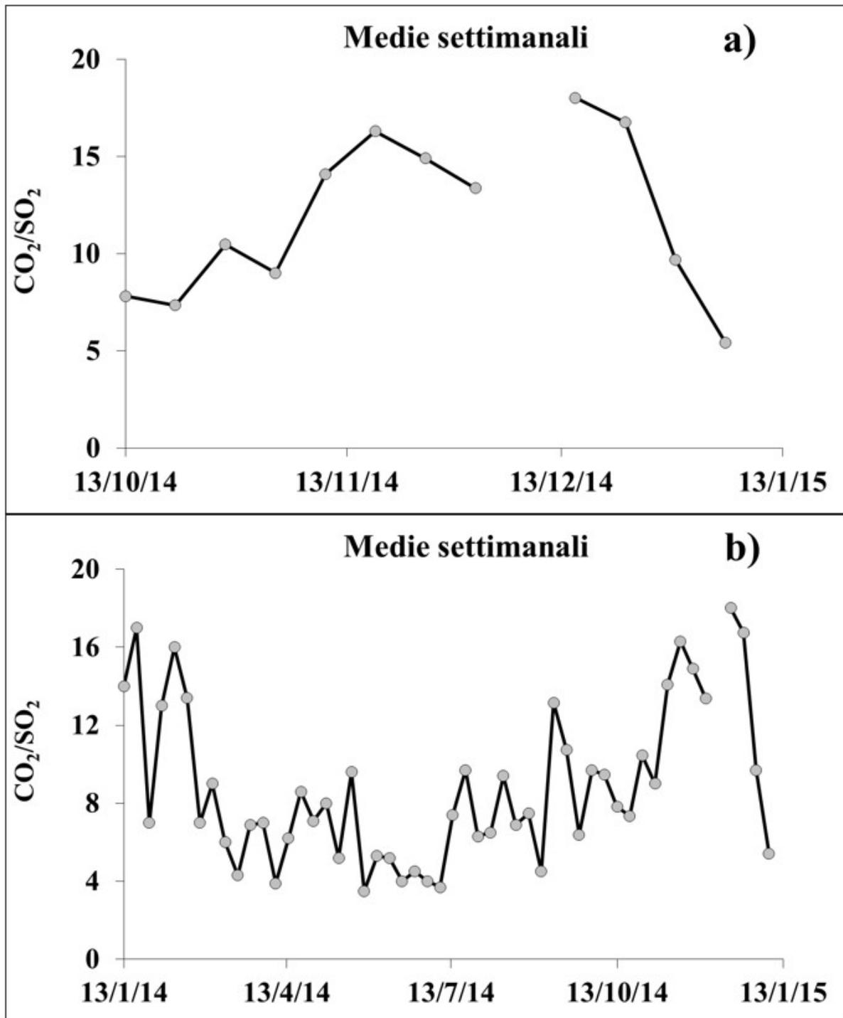
**Fig. 2.2** Andamento temporale del rapporto CO<sub>2</sub>/SO<sub>2</sub> nel plume: ultimi mesi (a), ultimo anno (b)
