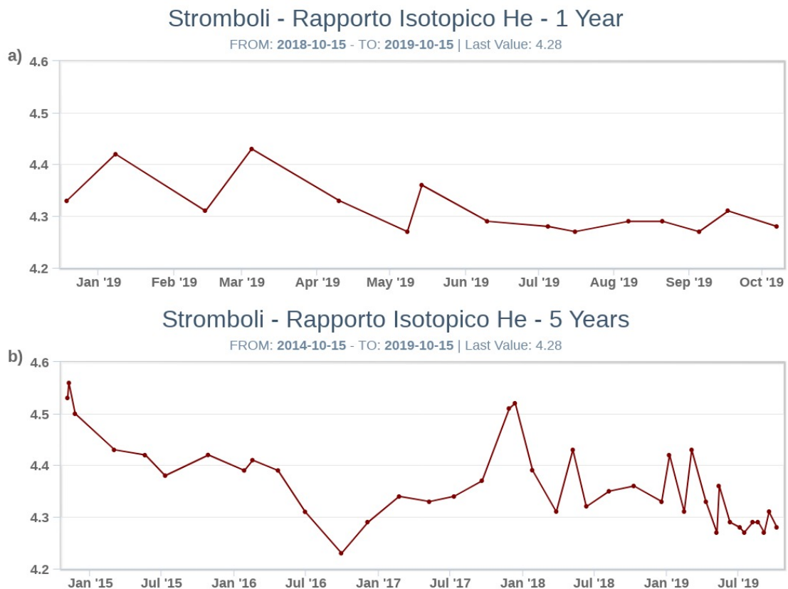
Fig. 6.3 - Andamento temporale medio del rapporto isotopico dell'elio disciolto nella falda termale: a) ultimo anno; b) ultimo quadriennio.
