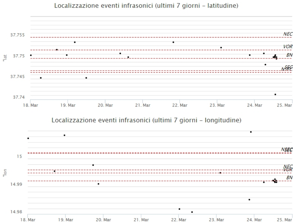
Fig. 5.2 - Andamento temporale dei parametri di localizzazione (longitudine e latitudine) degli eventi infrasonici localizzati nell'ultima settimana (SEC= cratere SE; VOR = cratere Voragine; NEC = cratere NE; BN = cratere Bocca Nuova)
