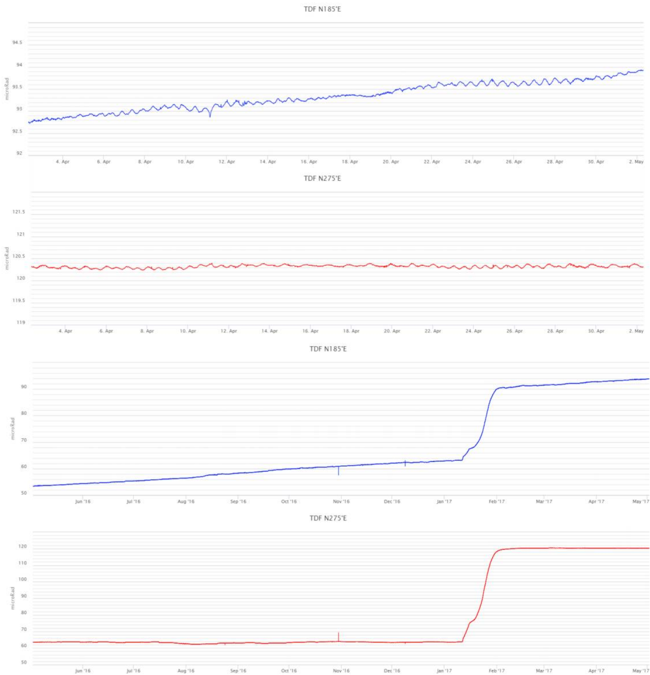
Fig. 3.1 Variazione dell'inclinazione del suolo alla stazione clinometrica di TDF. Sono riportate le 2 componenti di TDF nel breve (un mese, in alto) e nel lungo periodo (un anno, in basso).
