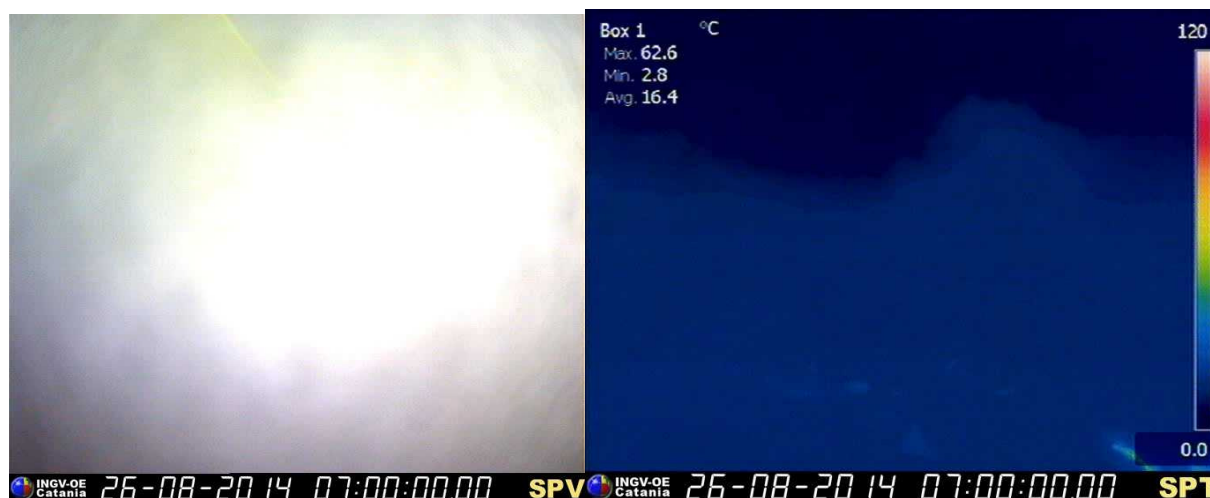
Figura 1 – Immagini visibile e termica della telecamera del Pizzo, acquisite alle ore 07:00 UTC di oggi, relative all'area craterica sommitale. In basso a destra nell'immagine termica si osserva l'anomalia termica corrispondente alla bocca effusiva che alimenta le colate laviche lungo la Sciara del Fuoco.
