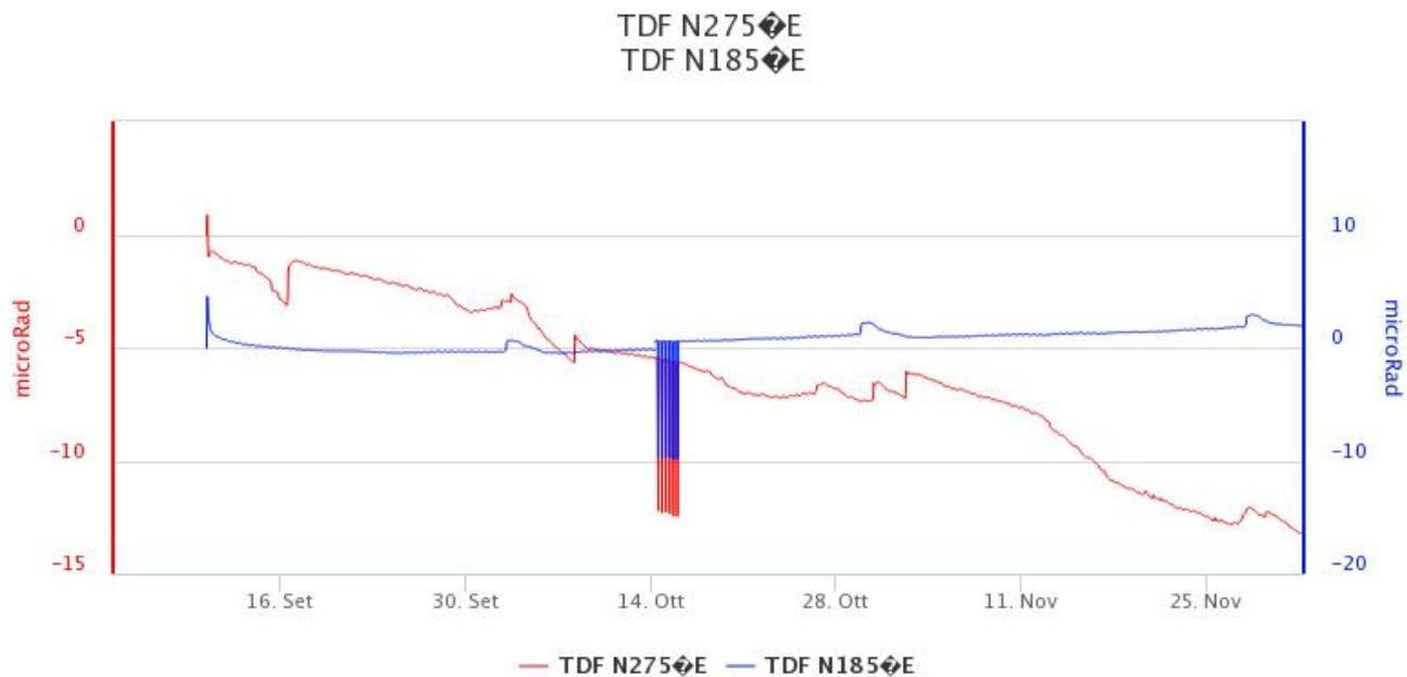
**Fig. 5.2** - Variazione dell'inclinazione del suolo alla stazione clinometrica di TDF [microstrain]. Sono riportate le 2 componenti di TDF negli ultimi 3 mesi di registrazione.
