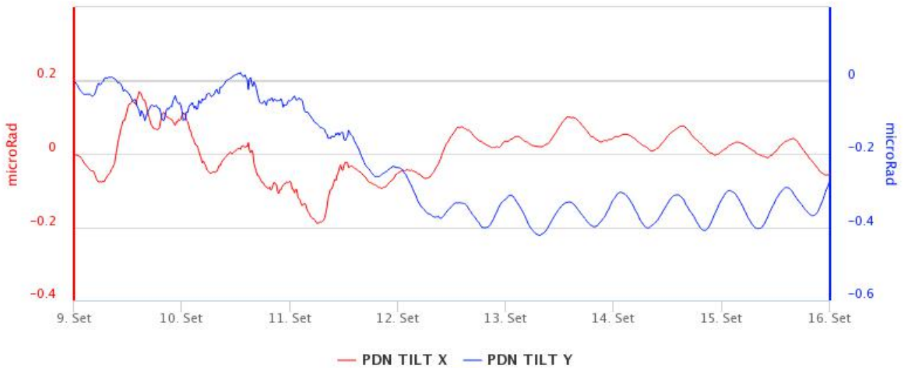
Fig. 6.3 - Serie temporale delle componenti X e Y del clinometro PDN
