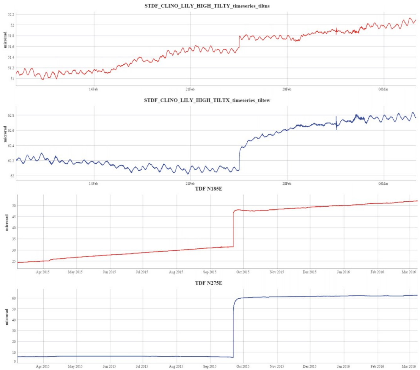
Fig. 3.1 Variazione dell'inclinazione del suolo alla stazione clinometrica di TDF. Sono riportate le 2 componenti di TDF nel breve (un mese, in alto) e nel lungo periodo (un anno, in basso).
