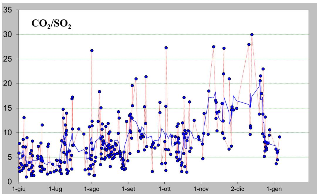
Fig. 3 – Rapporto CO<sub>2</sub>/SO<sub>2</sub> misurato nel plume vulcanico dello Stromboli nel periodo tra il 1 giugno e il 6 gennaio 2015 (ultimo dato ore 6:30 locali del 6 gennaio).
