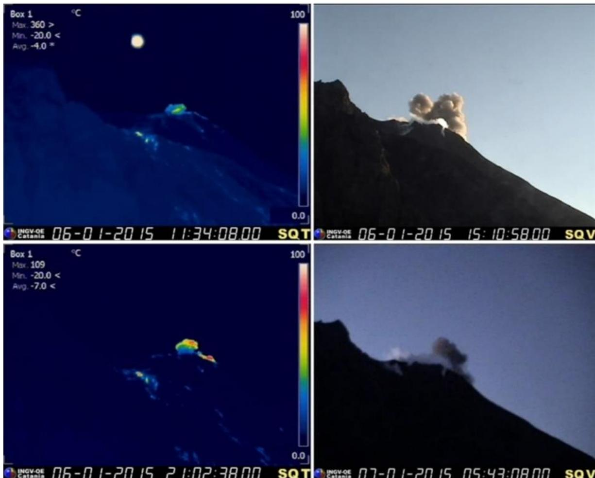
Fig. 1 – Immagini riprese dalle telecamere termica e visiva poste a quota 400 m sul lato nord della Sciara del Fuoco, che mostrano alcune delle emissioni di gas caldo e cenere, 6-7 gennaio 2015. Il punto luminoso in alto nella prima immagine è il sole.
