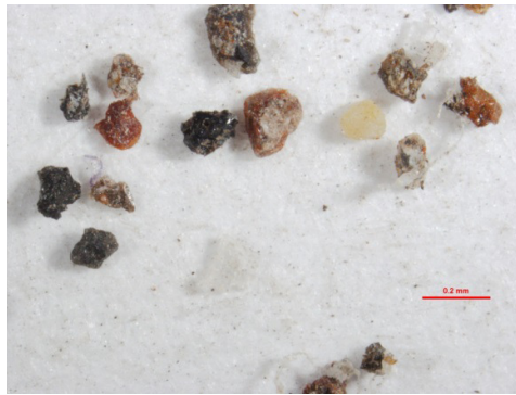
Figura 6 - Immagine acquisita allo stereomicroscopio che illustra le principali tipologie dei componenti della cenere.
