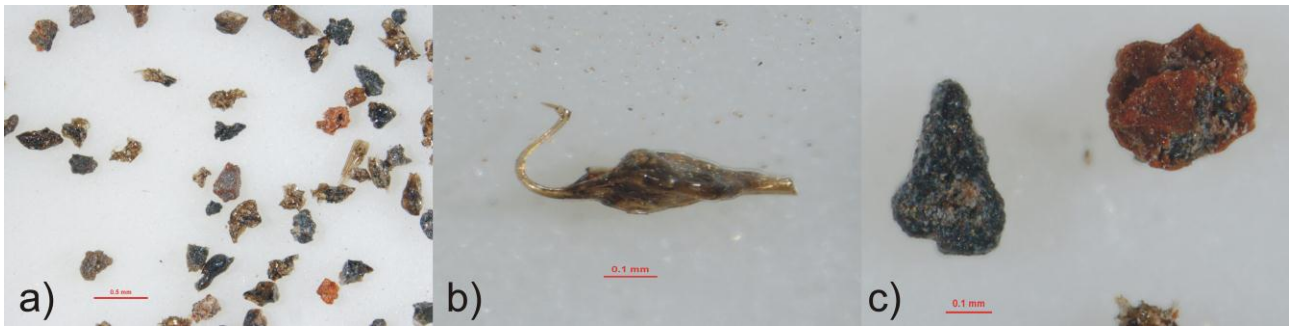
Figura 6. Immagini acquisite allo stereo-microscopio che illustrano: a) aspetto generale del campione di cenere (scala 0.5 mm); b) sideromelano con forma fluidale (scala 0.1 mm); c) litico scuro (a sinistra) e rosso (a destra) (scala 0.1 mm).
