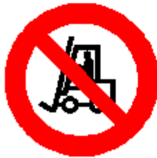
Vietato ai carrelli di movimentazione
