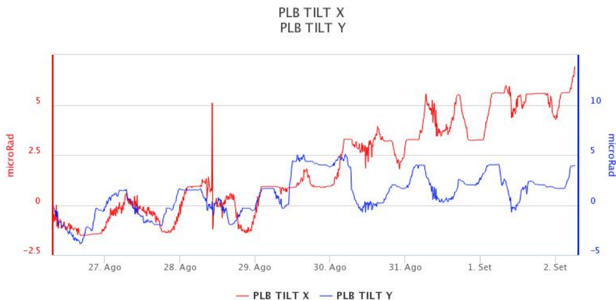
Fig. 5.2 - Variazione dell'inclinazione del suolo alla stazione clinometrica di PLB
